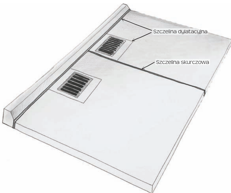
Rys. 6.13. Rozmieszczenie szczelin przy studzienkach
