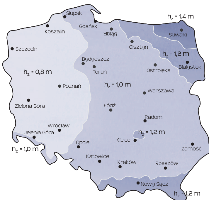
Rys. 3.7. Określenie głębokości przemarzania w Polsce
